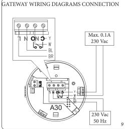
(\*) Collegare il Gateway ai morsetti di caldaia previsti indicati come 40 e 41 oppure 41 e 44 (vedi libretto istruzioni di caldaia)
